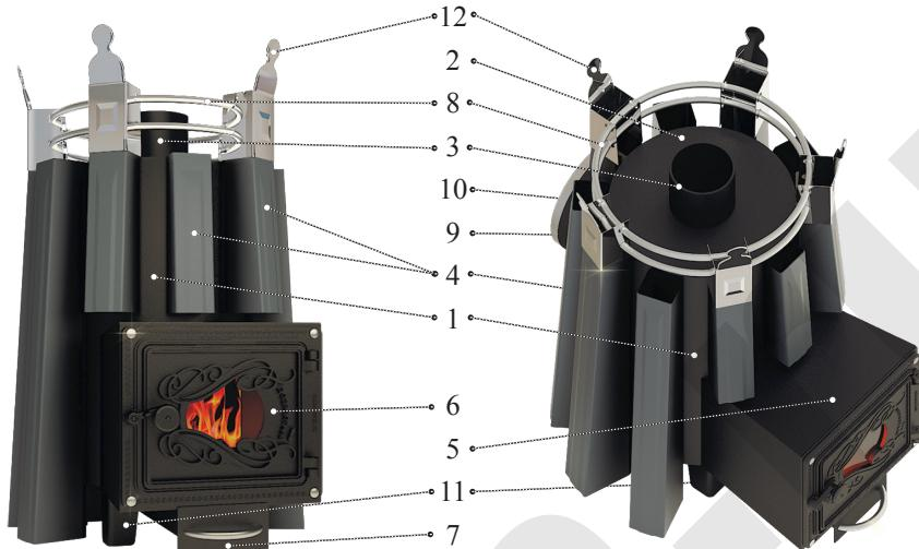
**Конструкция печи:** 1 – корпус; 2 – верхний свод; 3 – дымоходная гильза; 4 – конвективные пластины; 5 – топочный короб; 6 – топочная дверка; 7 – ящик-соков; 8 – открытая каменка; 9 – закрытая каменка; 10 – защитная крышка (или регулируемый диффузор); 11 – ножки; 12 – декоративные элементы.
